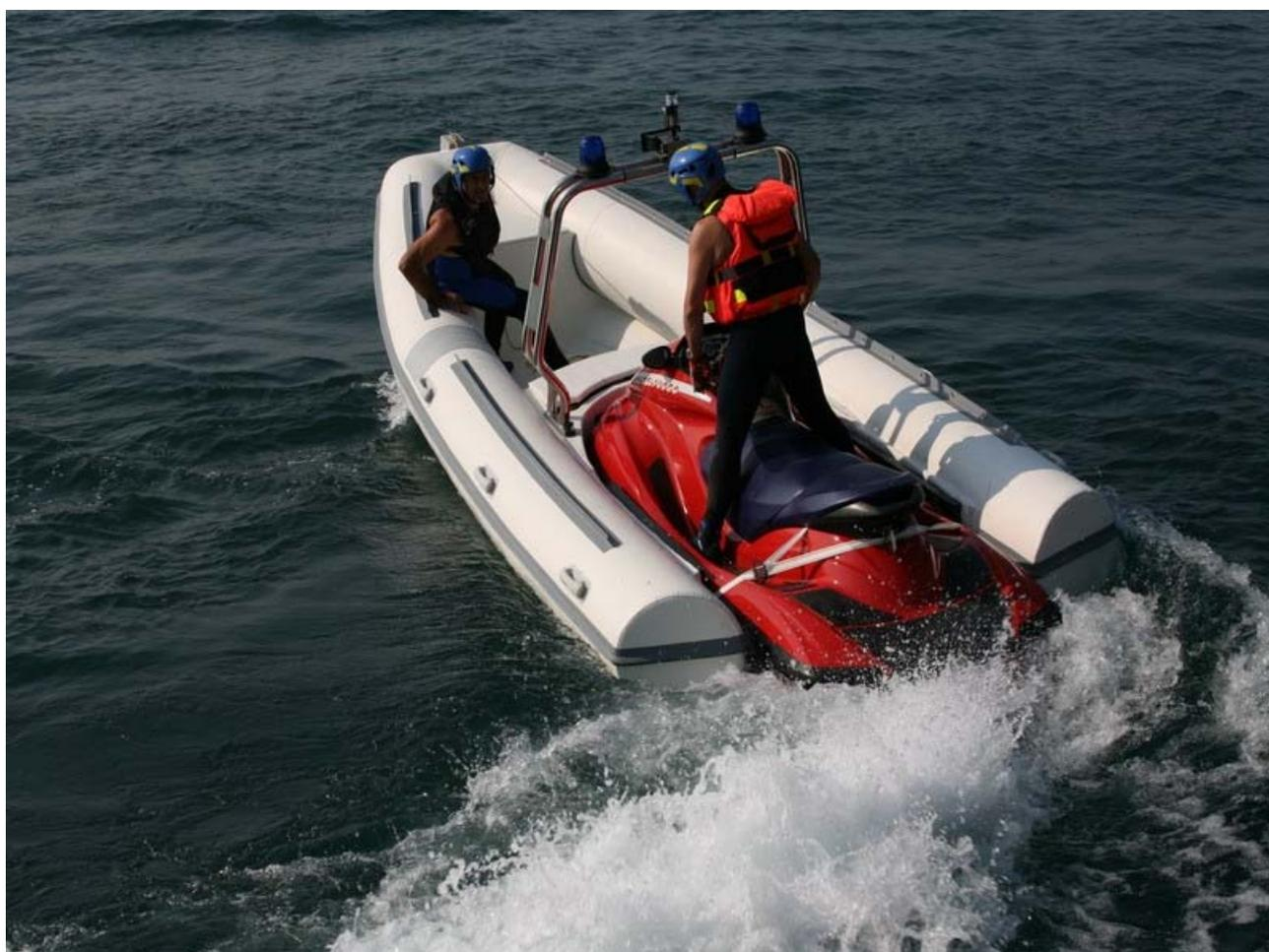
Lo scafo è disponibile nella tradizionale vetroresina, ma anche in alluminio oppure **kevlar®**; inoltre la leggerissima **schiuma espansa, ignifuga, elastica, a cellule chiuse, che riempie i tubolari**, garantendo l'autogalleggiamento con tutte le condizioni atmosferiche e tutte le condizioni di mare.
