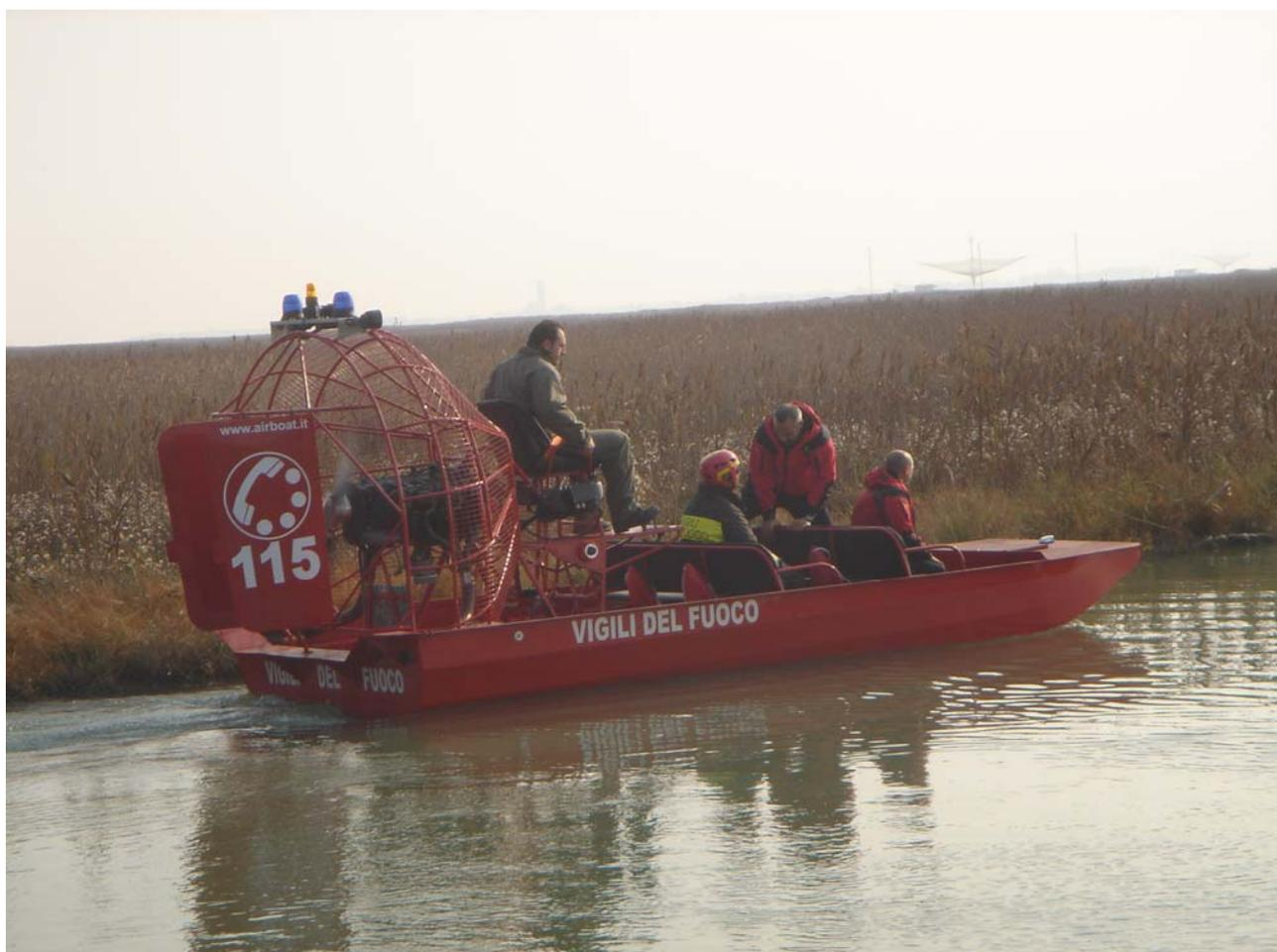
Le **airboat** non hanno freni efficienti e non sono in grado di spostarsi in retromarcia. Il caratteristico design a fondo piatto dell'imbarcazione fa sì che
