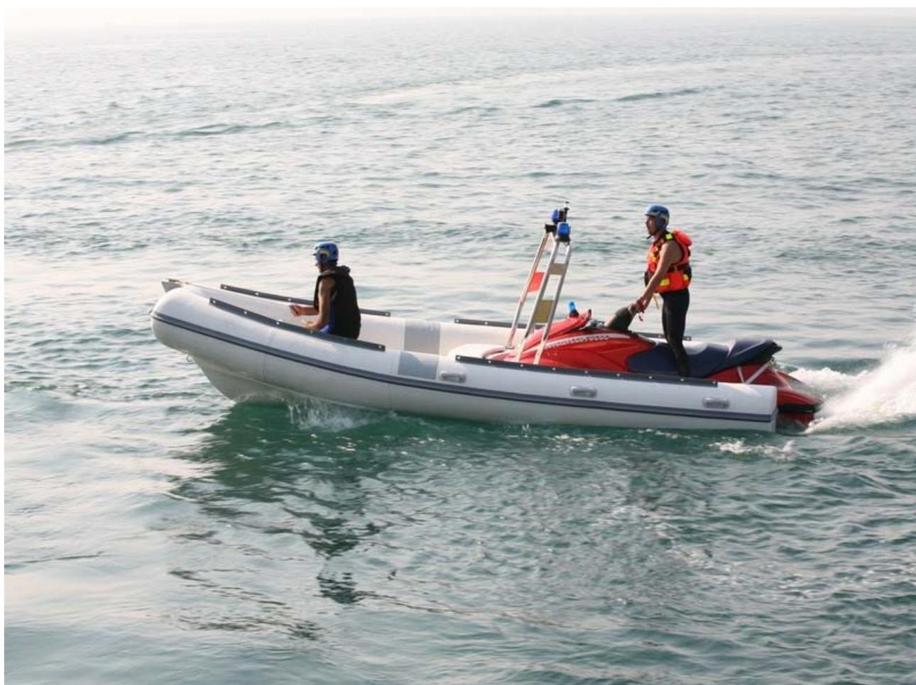
La versione antincendio del **Jetrescue**<sup>®</sup> é disponibile con barchino rigido oppure a gommone, entrambe riempiti di schiuma ignifuga a cellule chiuse autogalleggiante, oltre ad essere dotati di tutto il necessario per l'attività antincendio. La versione base si presta ad ogni e qualunque modifica su richiesta del cliente, così come la dotazione di molteplici optional, come ad esempio la **pompa antincendio da 2.700 litri al minuto con spingarda**.
